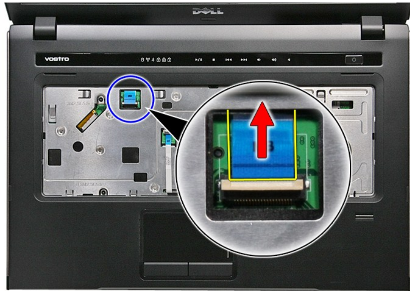
12. פתח את התפס המחבר את כבל הנתונים של לוח המגע ללוח המערכת.
